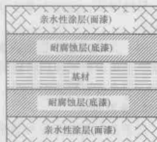
图 3-11 涂层结构示意图
