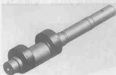
图 7-24 曲轴平衡块结构
