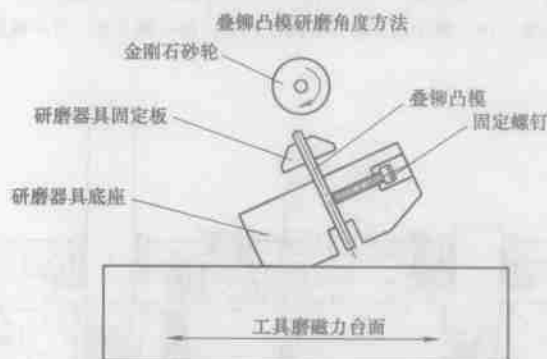
图 2-45 叠铆凸模研磨角度方法
