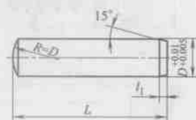
图 3-52 直杆型定位销钉
